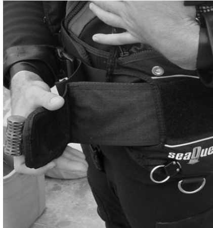
Gambar 58. Pemberat yang terintegrasi dengan BCD memiliki quick-release pockets
